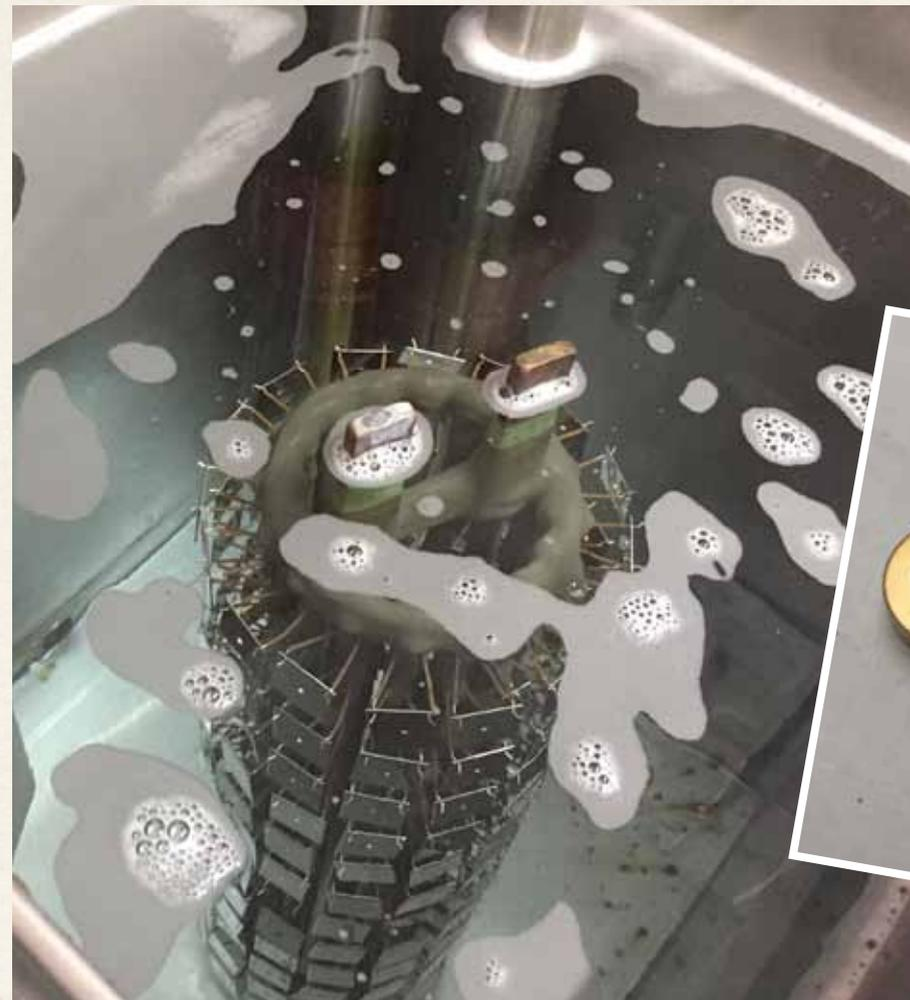
*Les pièces sont disposées sur un arbre métallique qui est ensuite plongé dans de multiples bains*
