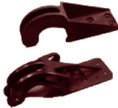
*Charnière de porte d'A320, pièce classique (haut) et pièce produite par fabrication additive après optimisation topologique (bas) (source : EADS)*
